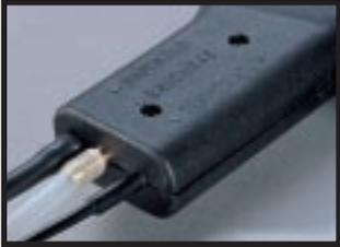
**3** Работая с этим прибором, нет необходимости пересоединять шланги для измерения тяги, так как измерение и индикация в дисплее происходят одновременно.
