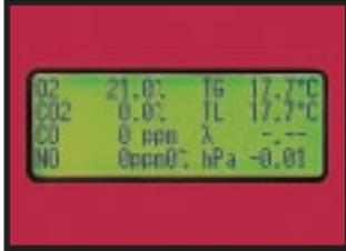
**4** Восьмизначная индикация измерительных данных на большом дисплее дает возможность охватить все измерения одним взглядом.
